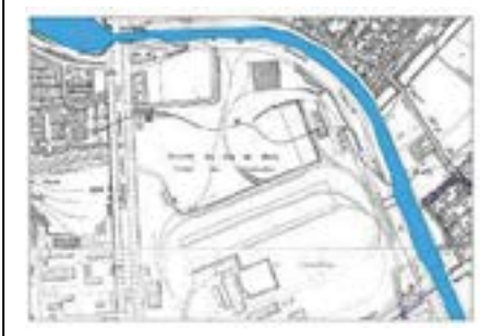
Plan de l'usine à gaz du Cornillon en 1939. On note les embranchements ferroviaires qui relient les estacades à l'usine.
